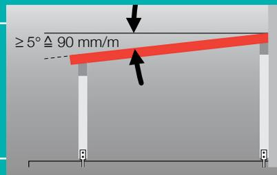
**2** Wir empfehlen Ihnen eine Dachneigung von mind. 5° ( $\Delta$  90 mm/m). So fließt das Regenwasser besser ab, die Verbindungen bleiben dicht und eine natürliche Reinigung durch das Regenwasser ist gewährleistet.
