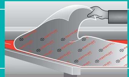
**13** Am Schluss entfernen Sie die Schutzfolie von den Makrolon® multi UV Platten die nicht länger als 24 Stunden unter Witterungsbedingungen bleiben soll, ...
