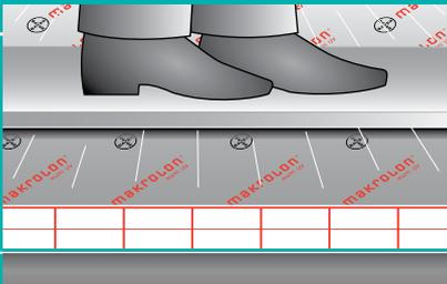
**11** Legen Sie die Makrolon® multi UV Platten auf die Sparren. Wichtig! Die UV Seite bitte immer nach außen bzw. oben legen. Die Kennzeichnung finden Sie auf der Schutzfolie und als Randprägung. Vermeiden Sie das Betreten der Platten. Wenn notwendig, legen Sie bitte quer zu den Platten eine Langbohle.
