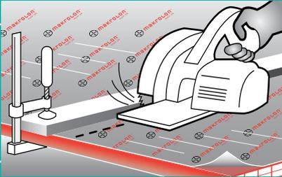
**6** Das Anzeichnen erfolgt mit einem weichen Stift auf der Schutzfolie, die auch für die weitere Bearbeitung bis nach der Montage auf der Platte bleiben soll. Zum Schneiden benutzen Sie handelsübliche Kreissägen mit ungeschränktem Vielzahnägeblatt und Hartmetallschneiden. Arbeiten Sie immer mit Anschlag.
