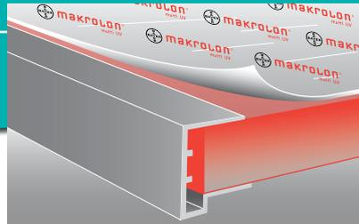
**10** Für das Verschließen der Plattenstirnseiten gibt es eine einfache, aber sehr wichtige Regel, um die Kondensatbildung möglichst gering zu halten: oben so dicht wie möglich (z.B. Abkleben der Kante mit Aluminiumband und Aufstecken eines Aluminium-Abschlussprofils evtl. mit Dich-
