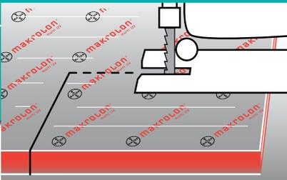
**9** Oft ist ein Eckausschnitt nötig (z.B. für Rohrleitungen, Lüftungen usw.). Verwenden Sie eine Stichsäge ohne Pendelhub. Für Bohrungen können Sie Spiralbohrer (Spitzwinkel  $\varphi$  110°-130°), Kegel oder Stufenbohrer verwenden.
