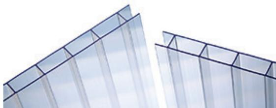
**Makrolon® multi UV 2/16-30** ist eine Doppelsteg-Polycarbonatplatte mit einer Dicke von 16 mm. Sie vereint hohe Lichtdurchlässigkeit mit Wärmedämmung und ausgezeichneter Witterungsbeständigkeit. Die Platte ist leicht, schlagzäh und einfach zu verlegen.
